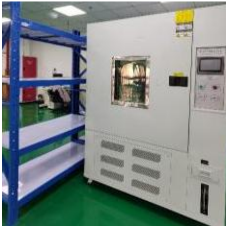
High & Low Temperature Test Chamber (고온 및 저온테스트 챔버)
