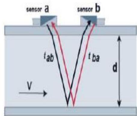
유체가 흐르고 있는 관내에 초음파를 조사하면 유체의 흐름에 따라 전파(tab Up-stream →Down-stream) 되는 초음파는 음속과 유속의 합에 비례하여 빨리 도달하고, 유체의 흐름을 거슬러서 전파 (tba Down-stream →Up-stream) 되는 초음파는 음속과 유속의 차에 비례하여 느리게 도달하게 되어 시간차(tab-tba)Δt가 발생하게 됩니다. 여기에서 발생하는 전파 Δt는 유체 속도의 상관함수이므로 이를 기초로 해서 음파 경로내 평균유속(V)를 연산하고 배관내경(d)의 단면적을 고려하여 다시 유량(Q)으로 계산하는 과정을 거치게 되고, 여기에서 초음파는 음파의 특성을 갖고 있으며 유체에 따라 고유의 유속을 갖고 통과하게 됩니다.
